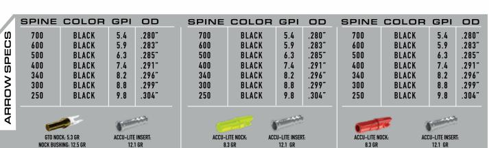
STRAIGHTNESS TOLERANCE: +/- .001" WEIGHT TOLERANCE: +/- .5 GR AVAILABLE IN 2" VANES & 2.75" FACTORY 4 FLETCHED
